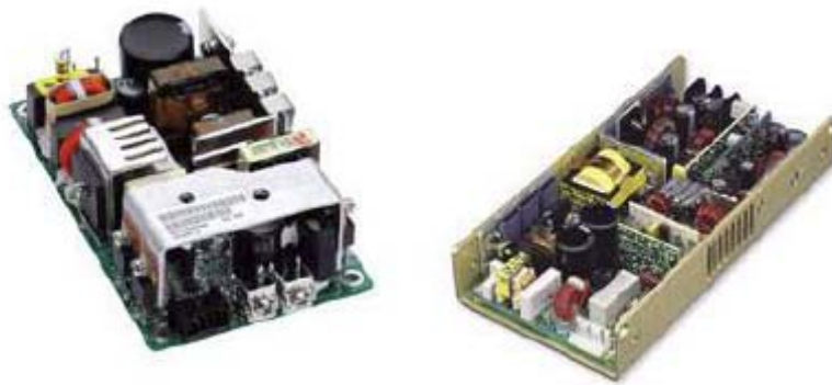
(b) 開放型構造の内部電源装置
