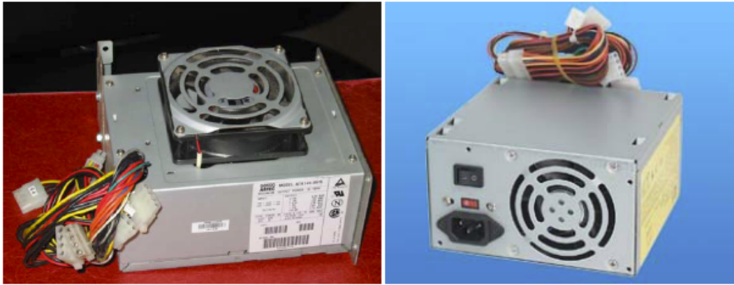
(a) 閉鎖型構造の内部電源装置
