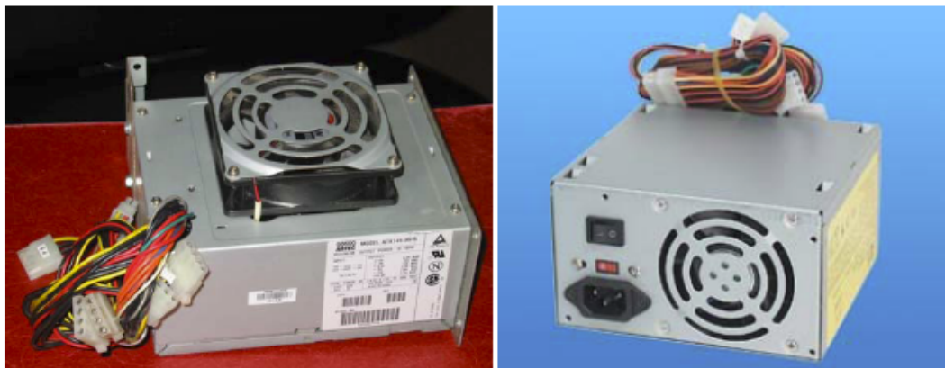
(a) 閉鎖型構造の内部電源装置
