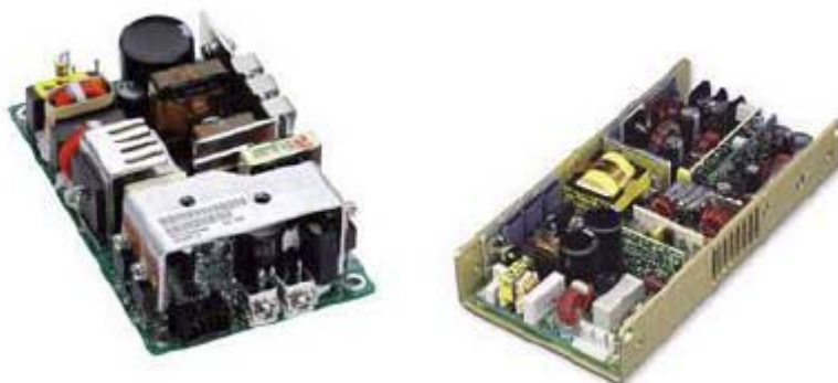
(b) 開放型構造の内部電源装置
